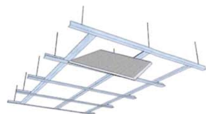
Hang het verwarmingspaneel in de plaats
