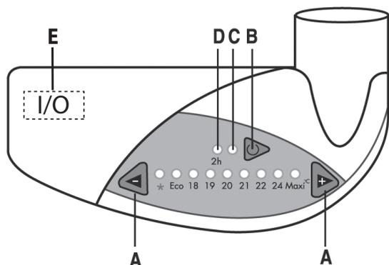
Nachdem Sie Ihr Gerät an Ihre Stromversorgung, drücken Sie die [I] Position des Schalters auf der Rückseite des Gerät zum einschalten
