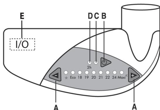
Nadat u het apparaat op de voeding aangesloten heeft drukt u op de [I] positie van de schakelaar. Deze schakelaar bevindt zich aan de achterzijde.
